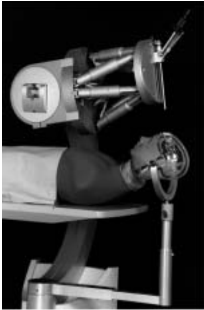
Bild 4: Operationssystem bestehend aus OP-Manipulator und OP-Cockpit (IPA)
