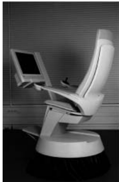
Bild 4: Operationssystem bestehend aus OP-Manipulator und OP-Cockpit (IPA)
